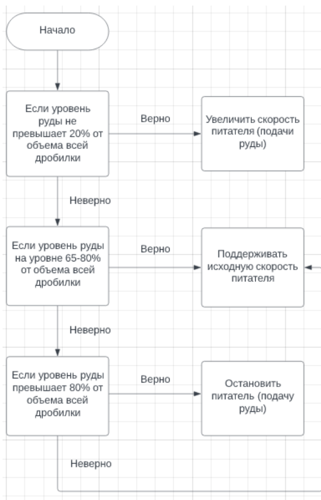
Рисунок 4.1 – Блок-схема алгоритма управления системой участка дробления
